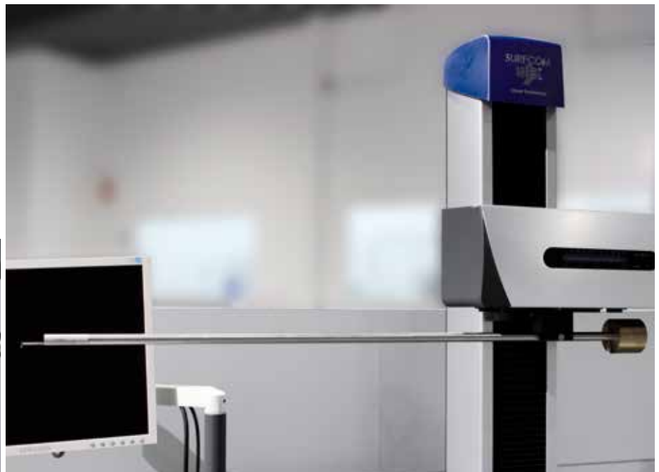
超长孔测量示例
