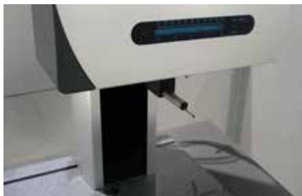
能通过安装支架实现横向测量
