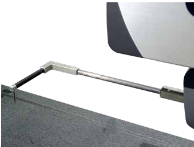
100mm高刚性90° 测臂安装示例
